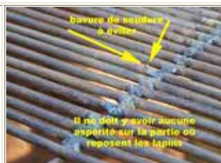
Figure 30c : Un essai de fabrication locale de fond de cage : les tiges sont inutilement grosses, pas assez espacées (il n'y a que 5 à 8 mm de vides entre 2 tiges) et il reste des bavures de soudure (agressif pour les pattes des lapins)
