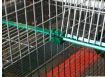
Détail de l'articulation de la mezzanine qui peut être relevée, avancée ou reculée pour faciliter l'accès aux lapins du niveau inférieur Matériel Chabeauti
