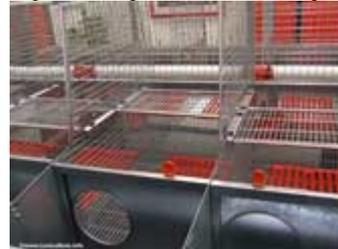
La mezzanine peut être avancée ou reculée en fonction de l'utilisation en disposition maternité ou engraissement Matériel Materlap
