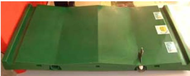
La forme en W recevant les déjections. Elle est réalisée en plastique rotomoulé. Les liquides sont évacués par une fente pratiquée au fond des 2 gorges du W, et les crottes par un racleur adapté.
