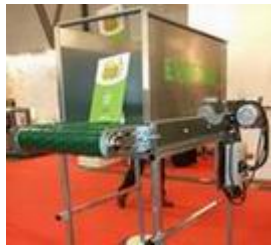
L' expédio , machine servant à décompacter automatiquement les balles de copeaux, distinguée par un Innov'Space (voir dossier page
